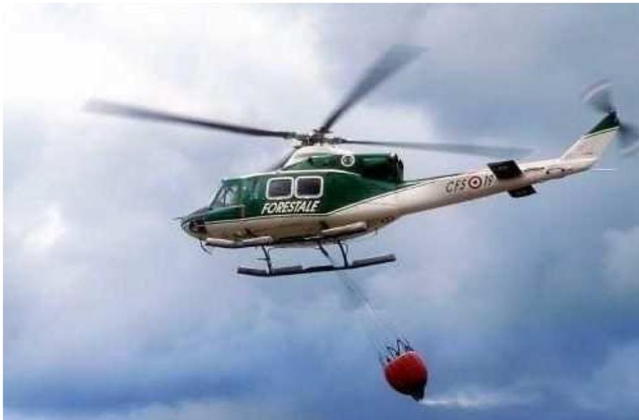
Aeromobile AB412 ad ala rotante servizio antincendio capacità cestello baricentrico litri variabili da 500 a 1.000 del Corpo Forestale dello Stato.
